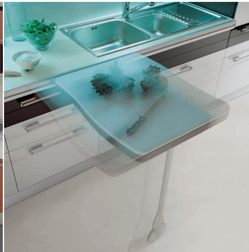
Το κατοχυρωμένο με δίπλωμα ευρεσιτεχνίας συρόμενο τραπέζι Fly κινείται χάρη στον οδηγό που είναι ενσωματωμένος στον πάγκο. Το Fly έχει επικάλυψη τεφλών, με ασάηλινο πόδι και ρόδα με πλαστικό δακτύλιο που διευκολύνει την κίνηση. The patented Fly sliding table moves thanks to the guide in the top. Fly has a worktop made from teflon, steel leg and wheel with a rubber ring that facilitates movement.
